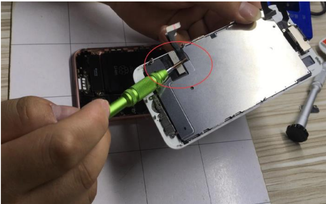
Imagen 1. Posición del cable flexible durante el montaje de la pantalla.
